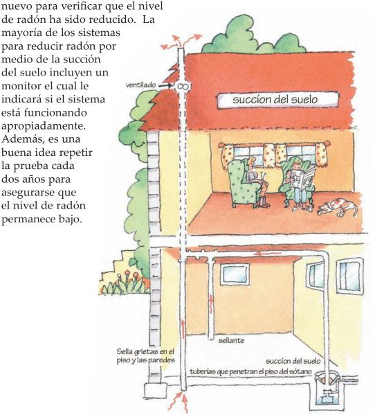
Nota: Este diagrama presenta diferentes opciones de mitigación. El sistema de mitigación más común usualmente tiene solamente una tubería que penetra el piso del sótano, esta tubería también puede ser instalada en la parte de afuera de la casa.
