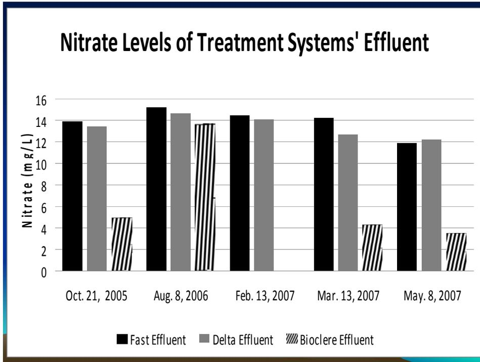
Figure 12. Effluent Nitrate concentrations.
