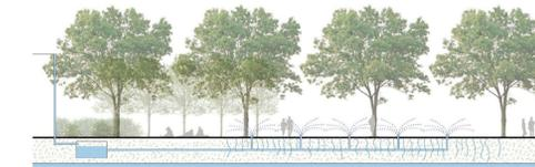
RAINWATER HARVESTING FOR IRRIGATION OF QUAD
