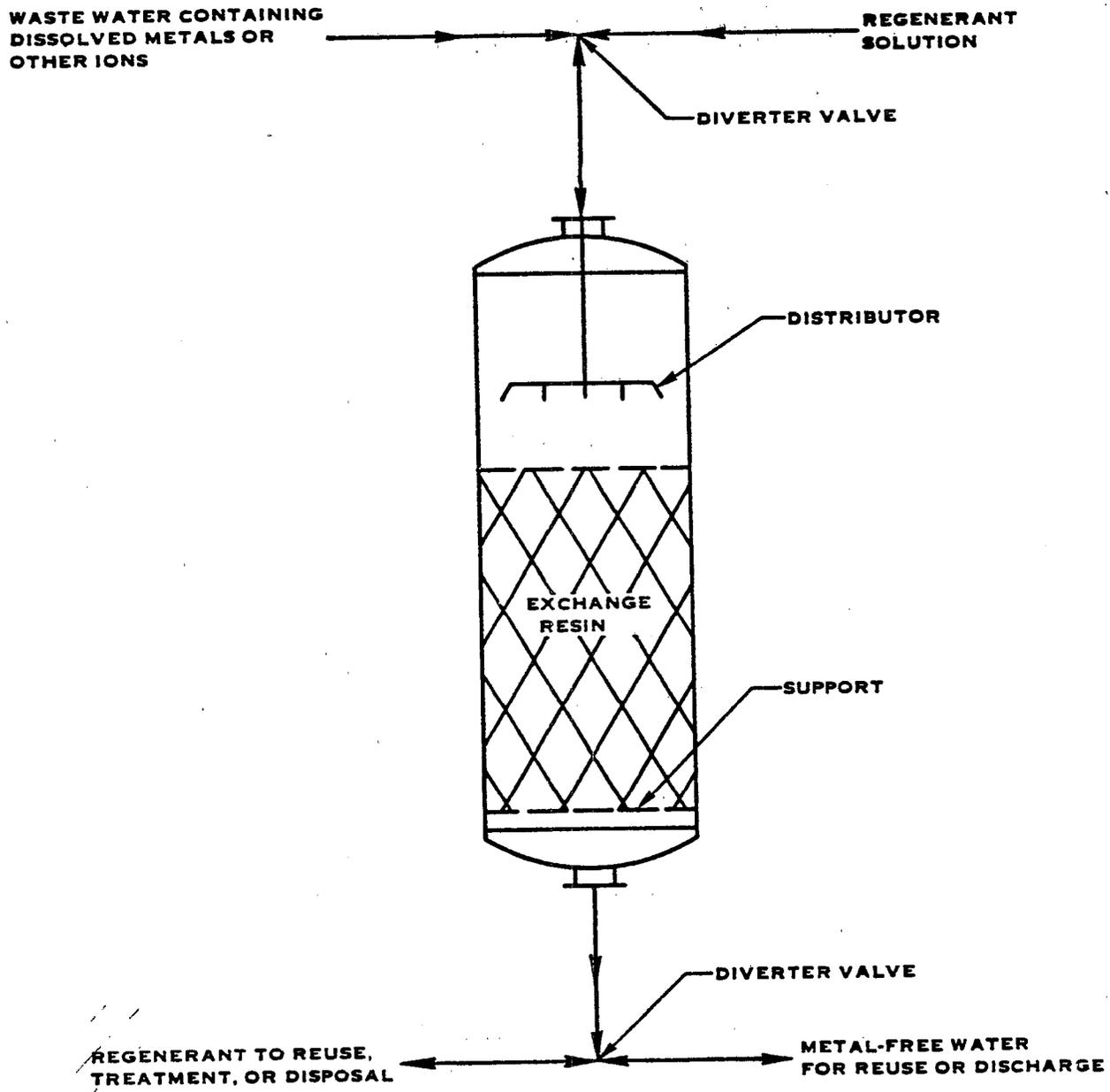
FIGURE VII-25. ION EXCHANGE WITH REGENERATION
