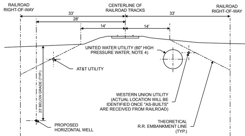
**TYPICAL SECTION - RAILROAD UNDERGROUND PIPING CONFIGURATION**
