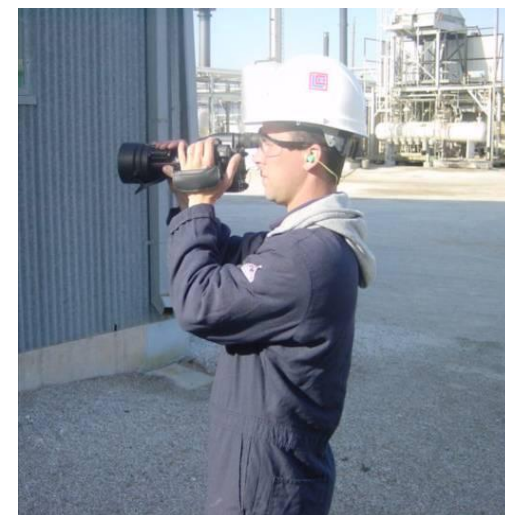
Камера инфракрасного обнаружения утечек
