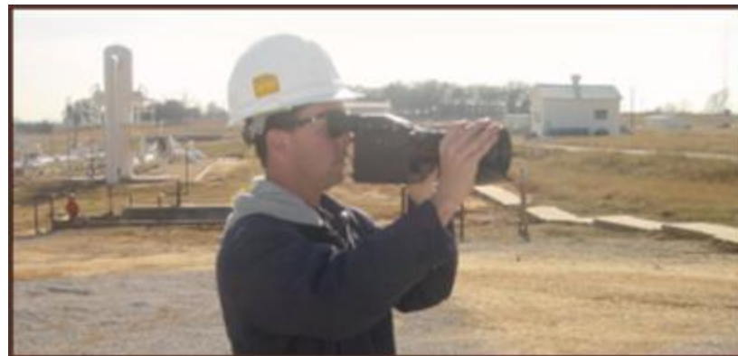
Источник: Обследование утечек, ручная камера
