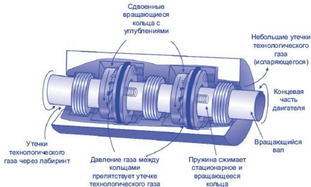
Источник: АООС, Принципиальная схема сухого уплотнения
