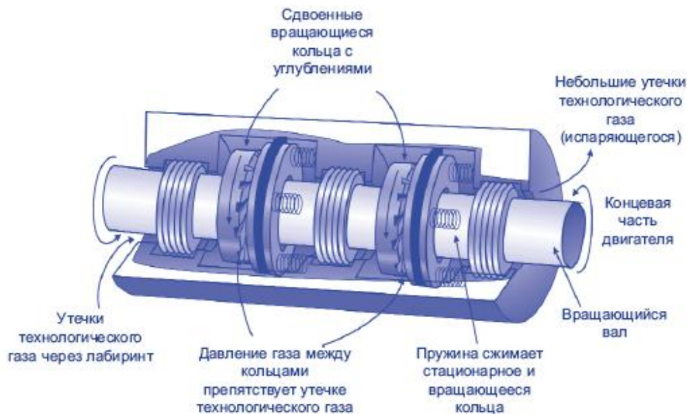
Источник: АООС, Принципиальная схема сухого уплотнения
