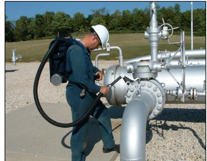
Medición de fugas usando el High Volume Sampler
