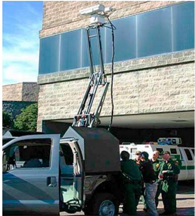
Los sistemas de vigilancia de vehículos móviles brindan la flexibilidad para adaptarse a las condiciones dinámicas de la frontera.
