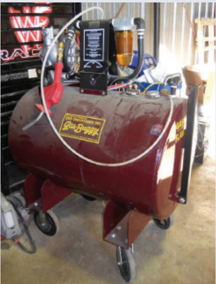
Bomba para remover desechos de combustible y un tanque de contención.
