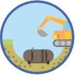
**Eliminación de tanques.** El suelo contaminado con gasolina o con otros combustibles se saca del sitio para dejar expuestos y extraer los tanques de almacenamiento subterráneos y los sistemas de tuberías. Luego pueden examinarse los suelos debajo del tanque en busca de contaminación y eliminar lo que sea necesario.
