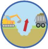
**Excavación.** Los contaminantes y suelos contaminados en la superficie o en el subsuelo se extraen y se transportan fuera del sitio para su tratamiento o desecho en un relleno sanitario. Puede usarse tierra limpia u otro material para rellenar el área excavada y crear una superficie nivelada apta para la reutilización.
