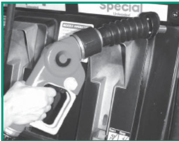
По Закону о чистом воздухе на АЗС в определенных зонах должны быть установлены пистолеты с системой улавливания паров. Такие пистолеты уменьшают выброс паров бензина в воздух во время заправки автомобилей.
