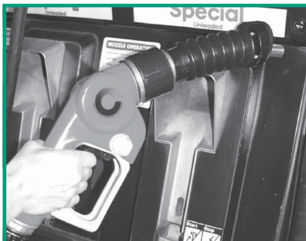
Đạo Luật Không Khí Sạch yêu cầu lắp đặt các vòi thu hồi hơi tại các trạm xăng ở một số khu vực nhất định. Những vòi phun xăng này làm giảm lượng hơi xăng xả vào không khí khi mọi người đổ xăng vào ô tô.
