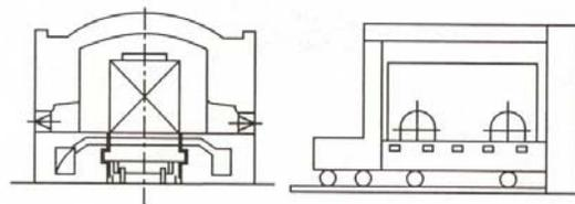
**Figure 2-9. Shuttle Kiln**
