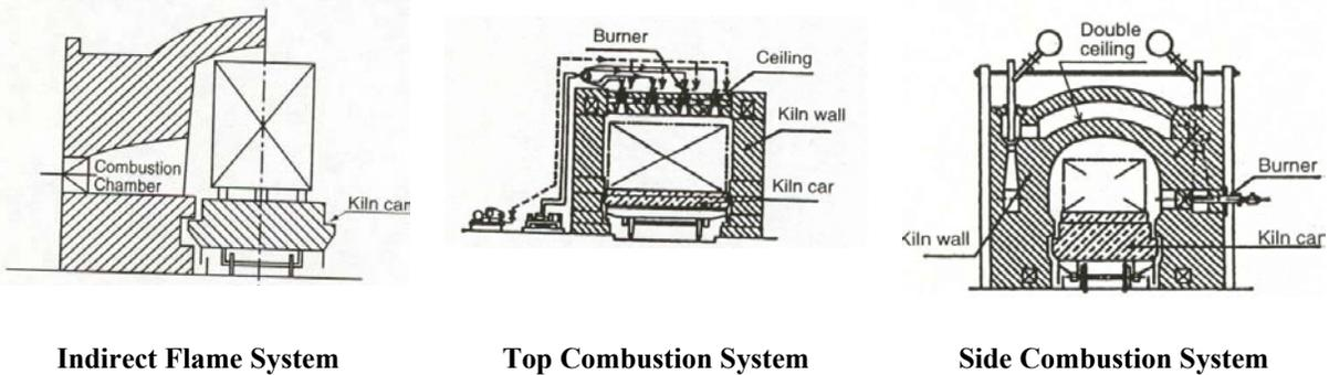
**Figure 2-7. Tunnel Kiln**
