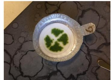
Figure 1. TSS Filter. Effluent TSS 105 mg/l
