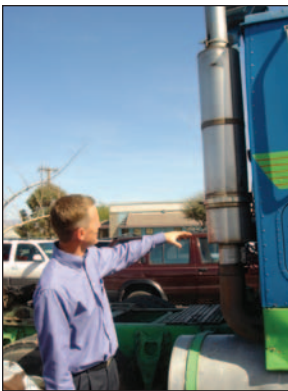
Tim Bradley, Gerente de Cuenta de Auto Safety House, describe el aparato de control de contaminación catalizador de oxidación de diesel.
